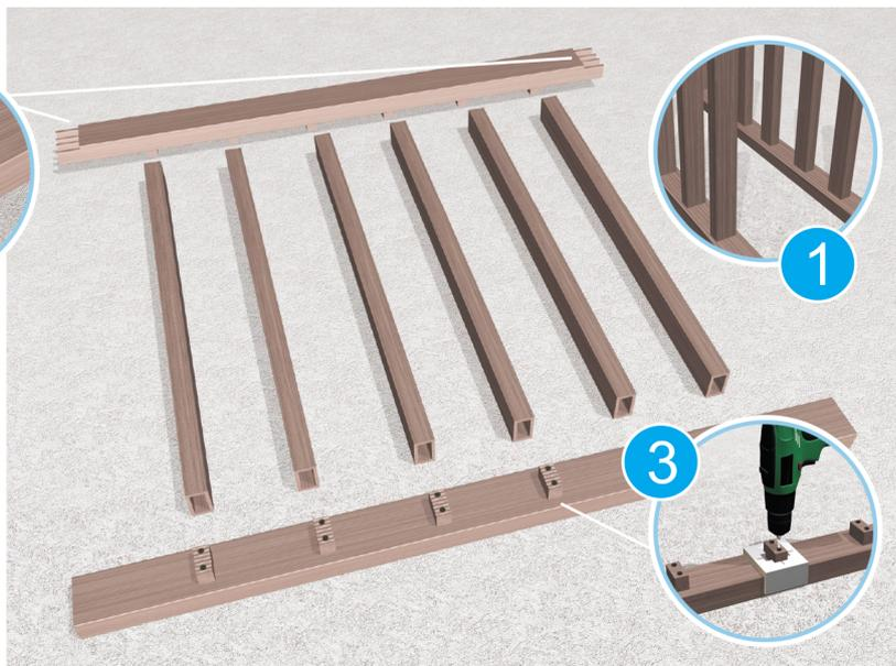
Существует два варианта сборки секции ограждения. Крепить баясины можно вдоль или поперек (1). Отрезать фрагменты подбалайсенников и баясин. В верхнем подбалайсеннике выпилить ниши для уголков (2) Просверлить отверстия под саморезы, диаметром на 1 мм меньше диаметра самореза. С помощью шаблона разметить и закрепить крепления для баясин (3).
