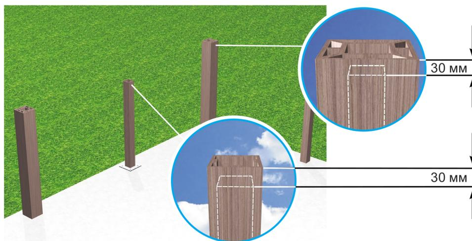
Просверлить отверстия в столбах с помощью шаблона, диаметром 12 мм. В угловых столбах два отверстия глубиной 100 мм. На разных гранях, на разной высоте.
