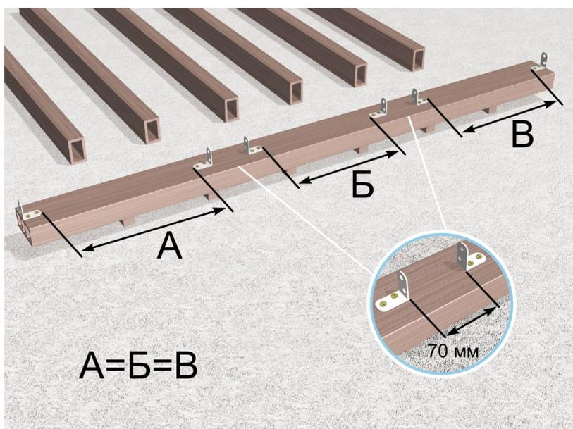
Просверлить отверстия под саморезы, диаметром на 1 мм меньше диаметра самореза. К нижнему подбалайсеннику прикрепить малые уголки, для того чтобы в последствии закрепить между ними опорные элементы (если длина секции до 800 мм - установить один элемент, если от 800 до 1200 мм - установить два опорных элемента). Два уголка закрепить по краям подбалайсенника в местах крепления к столбам.
