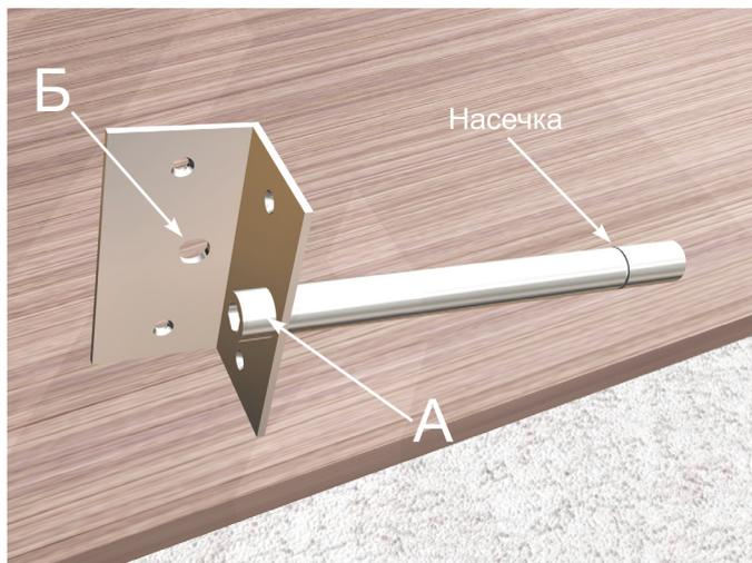
В угловом столбе втулки располагаются одна над другой. Для того чтобы сохранить одну высоту перил установить втулки в первый уголок в отверстие "А", во второй уголок - в отверстие "Б".
